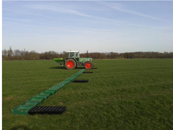
Afbeelding 8. Strooiertest met opvangbakken
