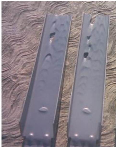
Afbeelding 4. Versleten schoepen beïnvloeden het strooibeeld
