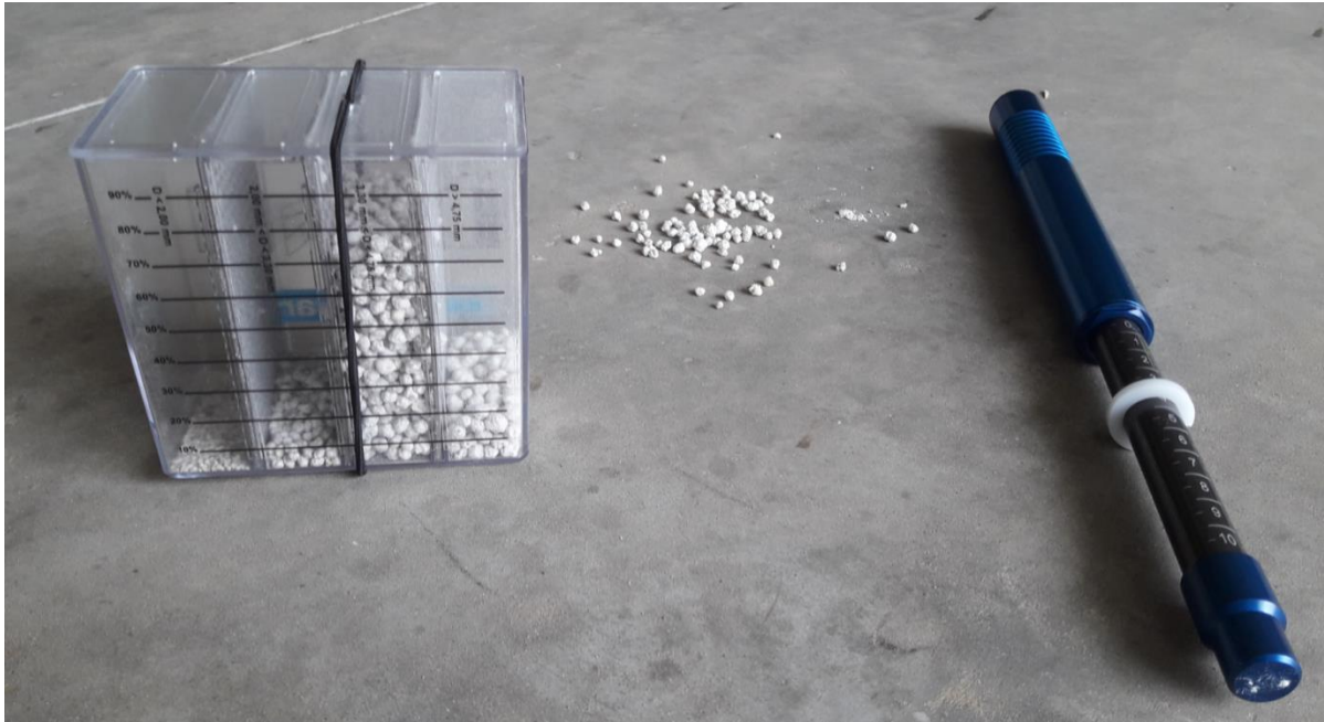
Afbeelding 1. Fractiemeter en hardheidsmeter voor kwaliteitscontrole korrelmeststoffen
