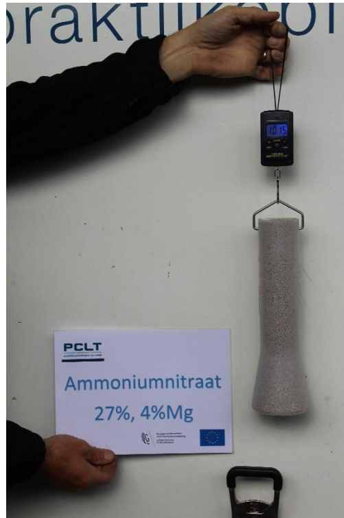
Afbeelding 3. Bepaling van volumegewicht
