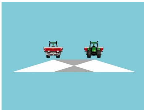
Afbeelding 6. Driehoekig strooi profiel bij kleinere werkbreedtes (<30m)
