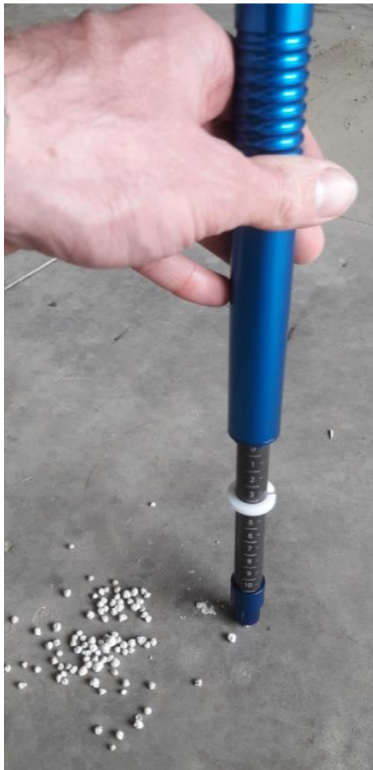
Afbeelding 2. Hardheidsmeting van kunstmeststoffen
